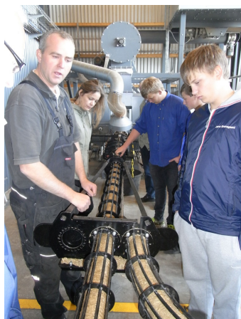
Figur 6: Demonstration af halm-brikettepressen. Foulum Biogasanlæg. (Klik på billedet for stor udgave).
