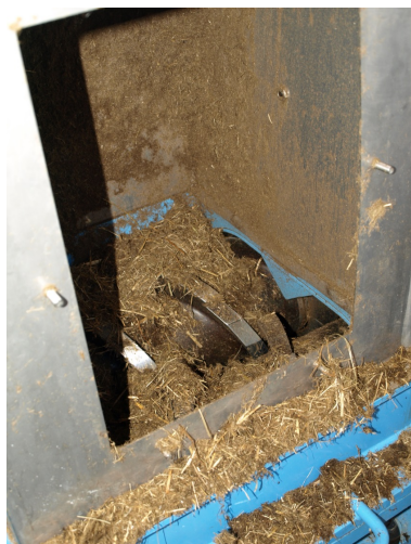
Figur 5: Extruderens kraftige stålsnegle presser og vrider halmståene fra hinanden. (Klik på billedet for stor udgave).
